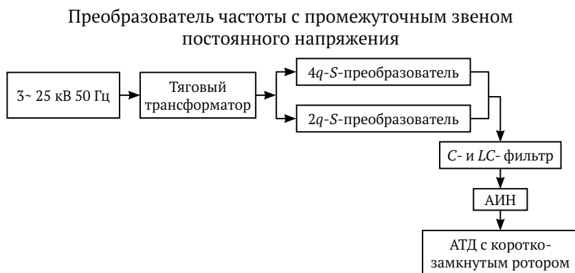
Рис. 6.2. Структурная схема силовой цепи электровоза типа «трехфазная тяговая сеть — тяговый трансформатор — преобразователь частоты — АТД с короткозамкнутым ротором»
