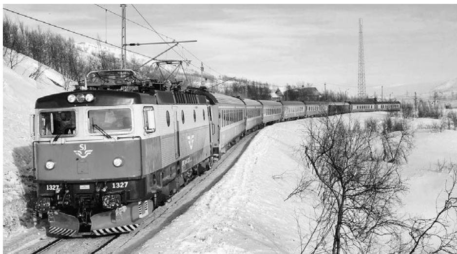
Рис. 2.9. Шведский локомотив R3 был первым локомотивом серии, в котором использовались тиристоры с двигателями постоянного тока
